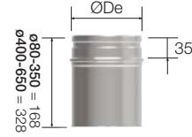
Módulo analizador de gas | Gas inspection module | Module d'inspection de gaz
